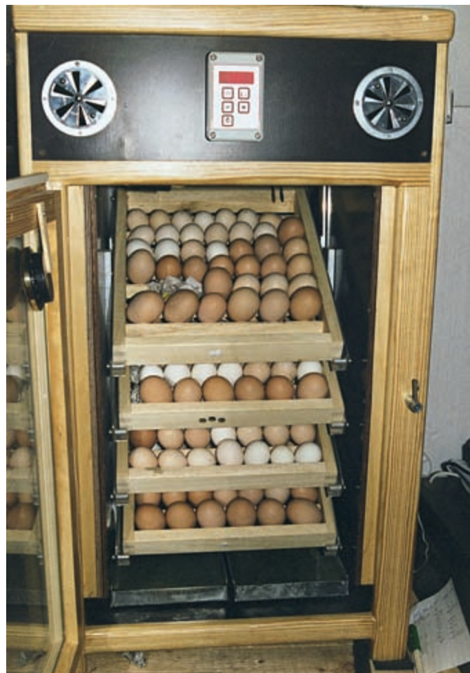
Moderne Brutmaschinen verrichten auch das Wenden der Eier automatisch, so dass der Arbeitsaufwand minimiert wird
